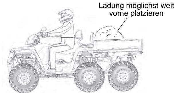
1. Die am Fahrzeug befindlichen Warnaufkleber zur Lastverteilung sind in jedem Fall zu lesen und zu befolgen. Die für dieses Fahrzeug ausgewiesene maximale Zuladung darf unter keinen Umständen überschritten werden.
